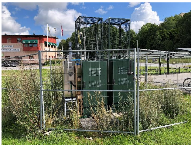
Figur 2. Instrumentens uppställning i Sollentuna. Det gröna skåpet i mitten innehåller EDM 180 instrumentet och referensprovtagaren är placerad bredvid.
