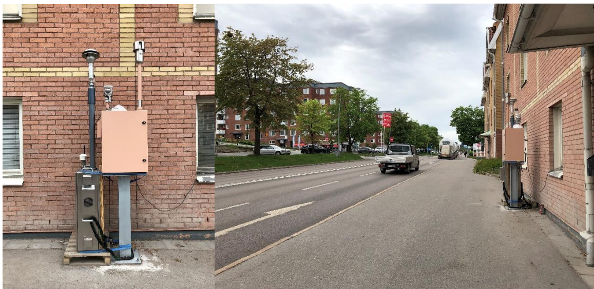
Figur 2. Instrumentens uppställning i Sundsvall, det ljusrosa skåpet innehåller Fidas 200 instrumentet och referensprovtagaren är placerad bredvid.
